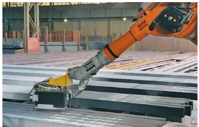
Knüppelmarkierung mit Heißsignierfarbe an Roboter
