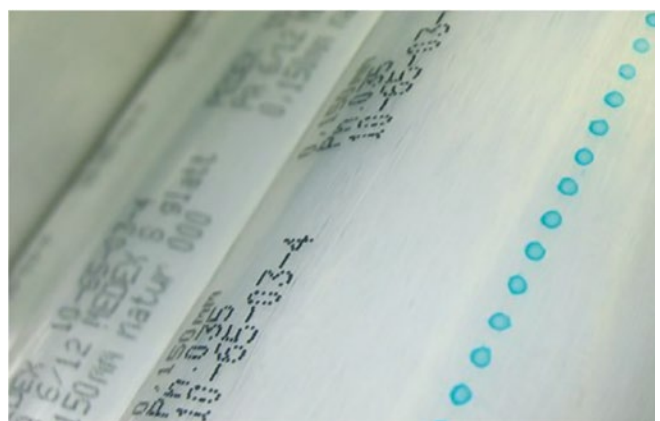
Kontrolllinie auf PE-Folienschlauch
