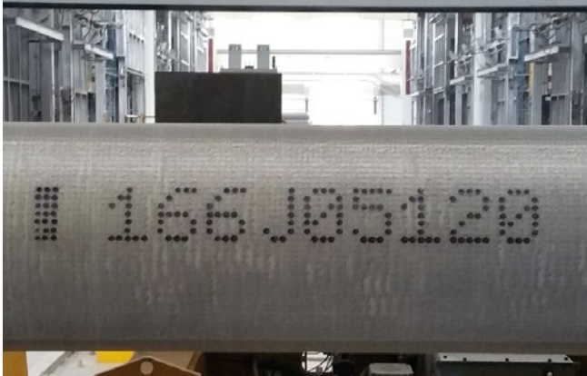
Aufbringen von Glühfarben auf Aluminiumbarren
