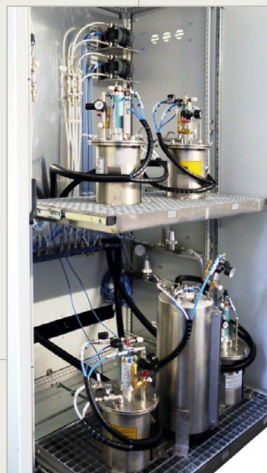
Farbversorgungsschrank mit 4 Farb- und 1 Spülmitteldruckbehälter
